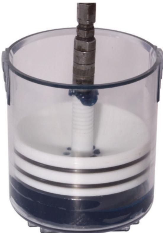
2. Nun wird das zu schmierende Lager einfach eingespannt.
