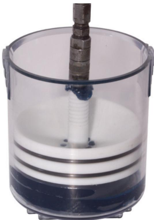
2. Il faut positionner le palier qui doit être graissé.
