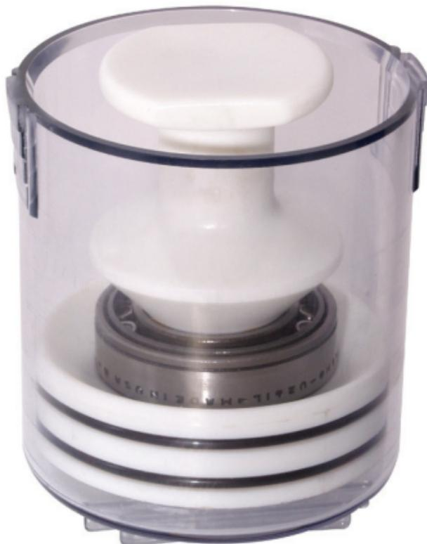
3. Appuyez ensuite le piston vers le bas et grace au procédé breveté la graisse est pressée dans les rouleaux, c'est à dire à l'endroit où elle doit se trouver pendant le fonctionnement.
