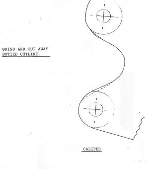
MODIFICATIONS TO FLANGE & CALIPER SCALE 1:1 .
