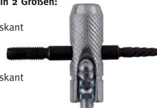
Reinigungspressen „NIPPELFIPS“ durch Hammer Schlag wird dünnflüssiges Öl mit extrem hohem Druck eingepresst, löst jeden verklemmten, verharzten, verrosteten Schmiernippel und macht das Lager wieder gängig.
