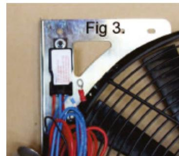
5. Befestigen Sie die neue Lüfterbaugruppe mit den vier M5 Schrauben, den Unterlegscheiben und Muttern an der oberen Kühlerabdeckung und senken Sie diese Abdeckung anschließend vorsichtig in ihre Position ab, wobei Sie darauf achten müssen, dass die Rtec Lüfterbaugruppe in die beiden originalen unteren Halterungen des Kühlerrahmens passt (Abb. 4).
