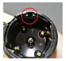
2. Die Verteilerkappe im markierten Bereich minimal abfeilen.
