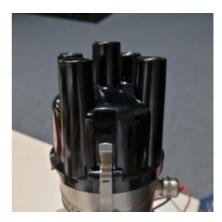
Die Verteilerkappe passt danach einwandfrei und die Klammern des 123-Zündverteilers greifen perfekt in die Aussparung der Verteilerkappe.
